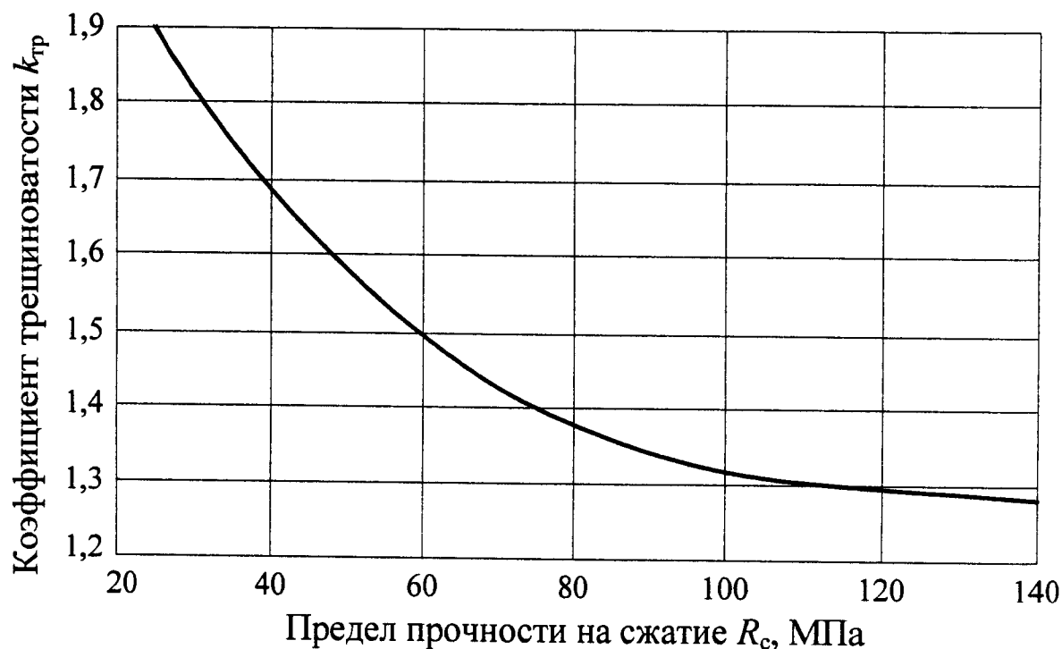
Рис. 1. Изменение коэффициента трещиноватости пород от их предела прочности на сжатие
