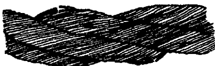
Рисунок 1. Обрывы и смещения проволок каната крестовой свивки
