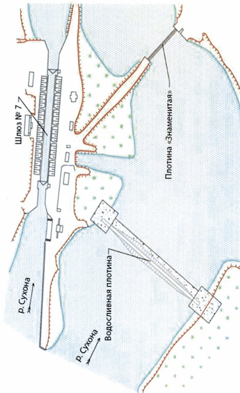
Схема расположения сооружений гидроузла Кубенского водохранилища и водосливной плотины на р. Сухоне
