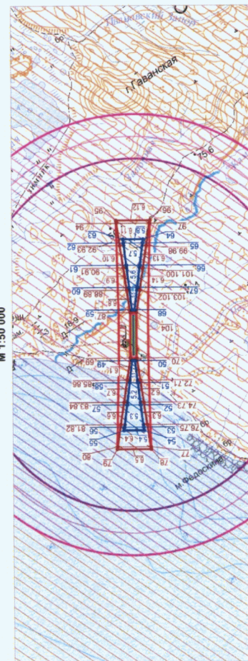
Схема секторов и характерных точек поверхностей взлета и захода на посадку М 1:50 000
