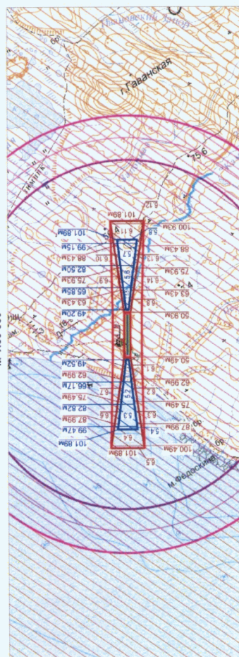
Схема секторов с указанием ограничения по высоте строительства объектов в пределах поверхностей взлета и захода на посадку М 1:50 000
