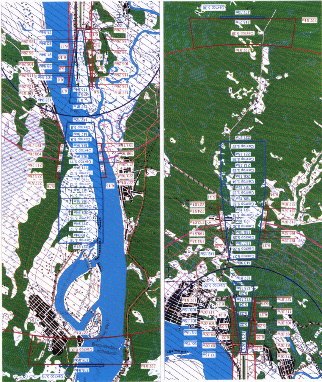
Схема секторов с указанием ограничения по высоте строительства объектов в пределах поверхностей взлета и захода на посадку М 1:50 000
