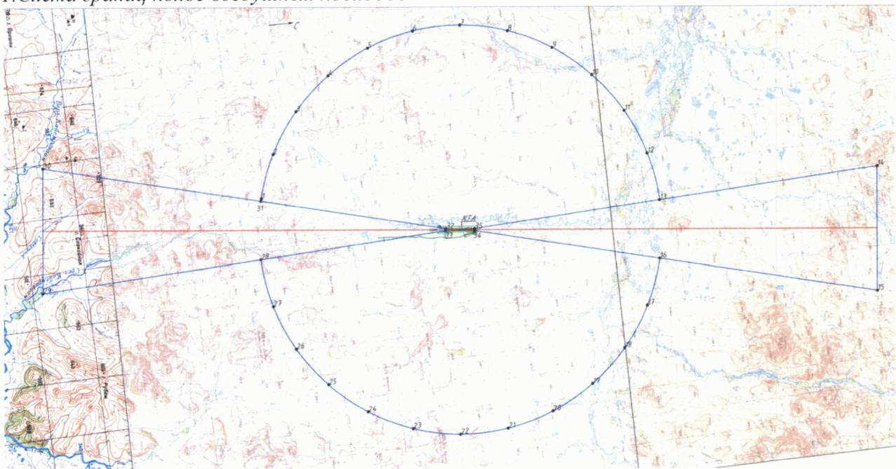
2. Схема внешней горизонтальной, конической и внутренней горизонтальной поверхностью ограничения препятствий
