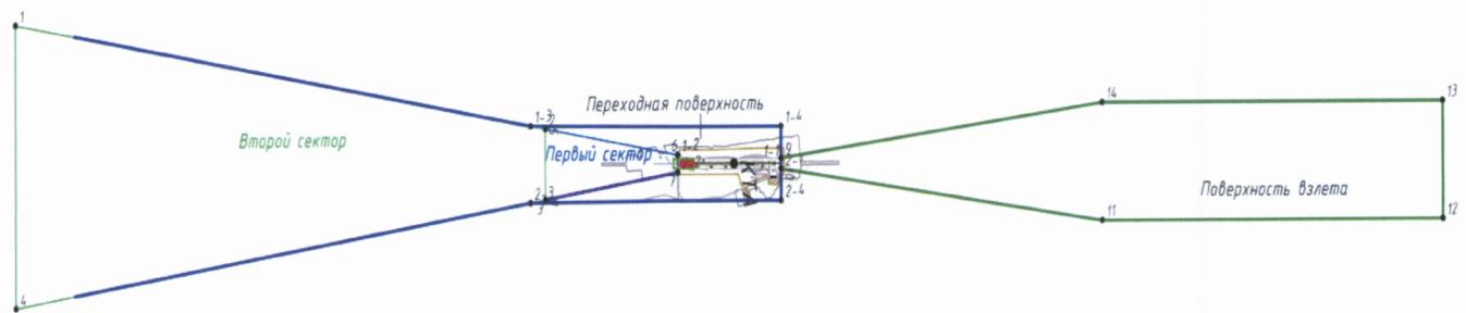
4. Схема поверхности захода на посадку, переходных поверхностей и поверхности взлета для ВПП с МК=190°
