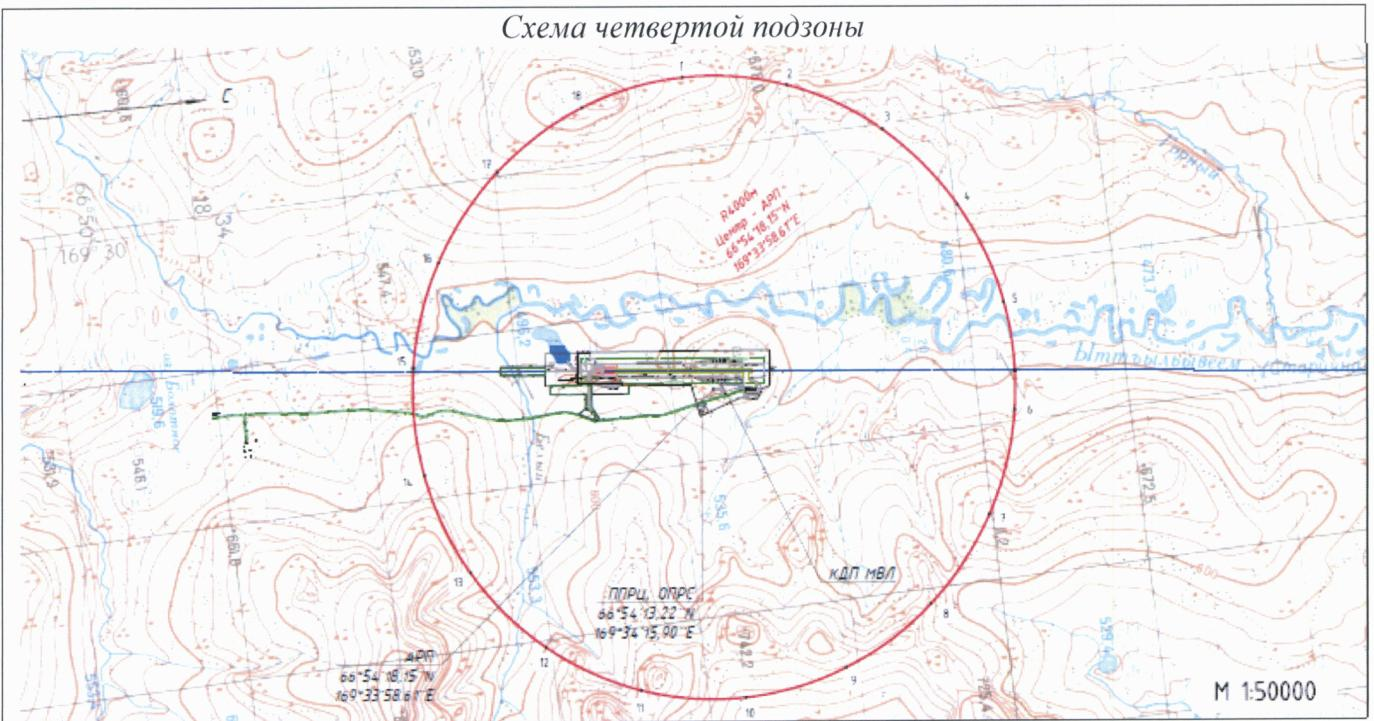
8.5. Графическое изображение границ сектора ограничения застройки по высоте с секторами, в которых устанавливается ограничительная высота размещаемых объектов, создающих помехи в работе наземных объектов средств и систем обслуживания воздушного движения, навигации, посадки и связи.
