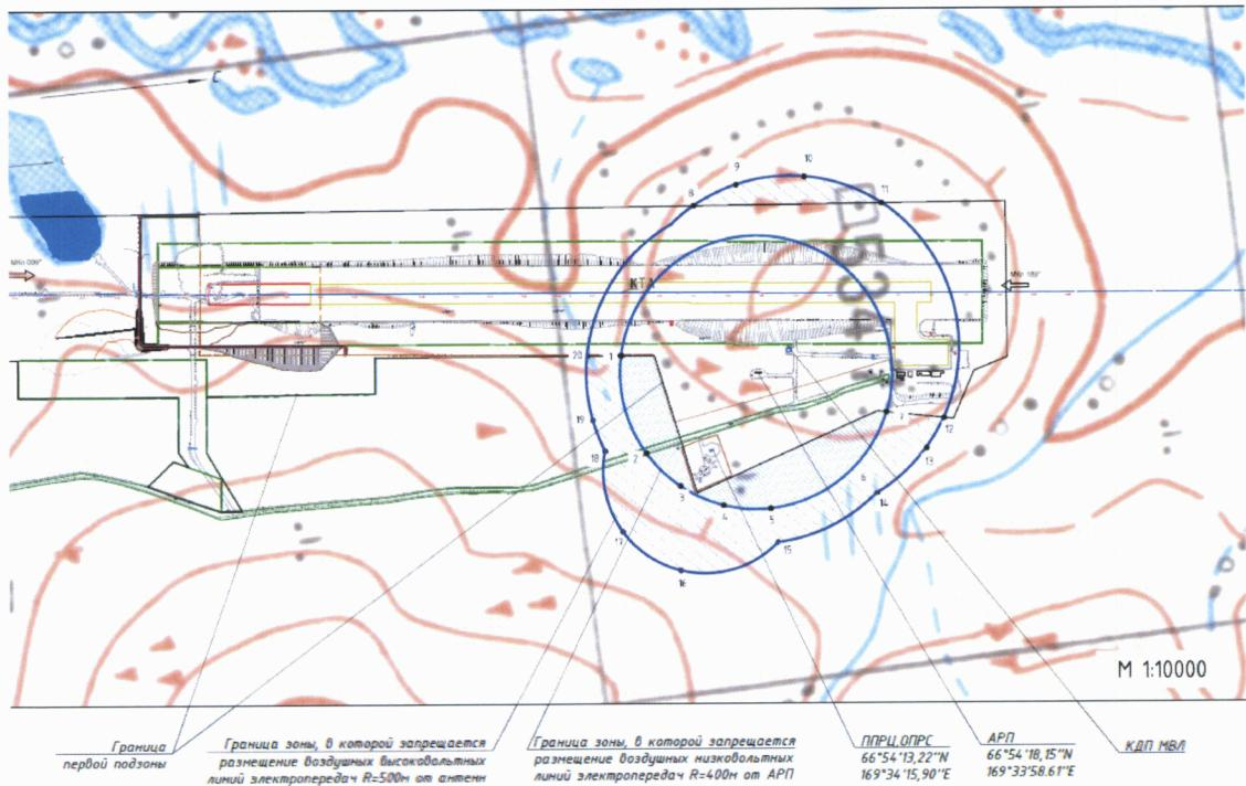
2. Схема зоны, в которых запрещается размещение сооружений, имеющих значительные металлические массы (мосты, железные дороги, промышленные и другие крутые строения).
