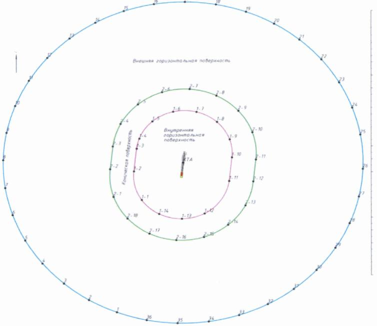
3. Схема поверхности захода на посадку, переходных поверхностей и поверхности взлета для взлетно-посадочных полос (далее – ВПП) с МК=010°
