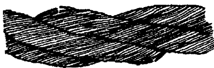
Рисунок 1. Обрывы и смещения проволок каната крестовой свивки
