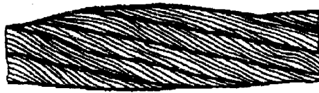
Рисунок 13. Местное увеличение диаметра каната
