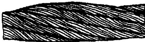
Рисунок 13. Местное увеличение диаметра каната.
