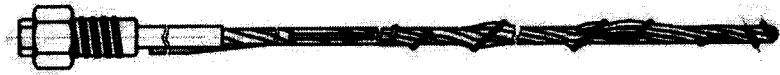
Рис. 10. Общий вид канатного анкера типа АК02. Предназначен для ампульно-нагнетательного или нагнетательного закрепления.
