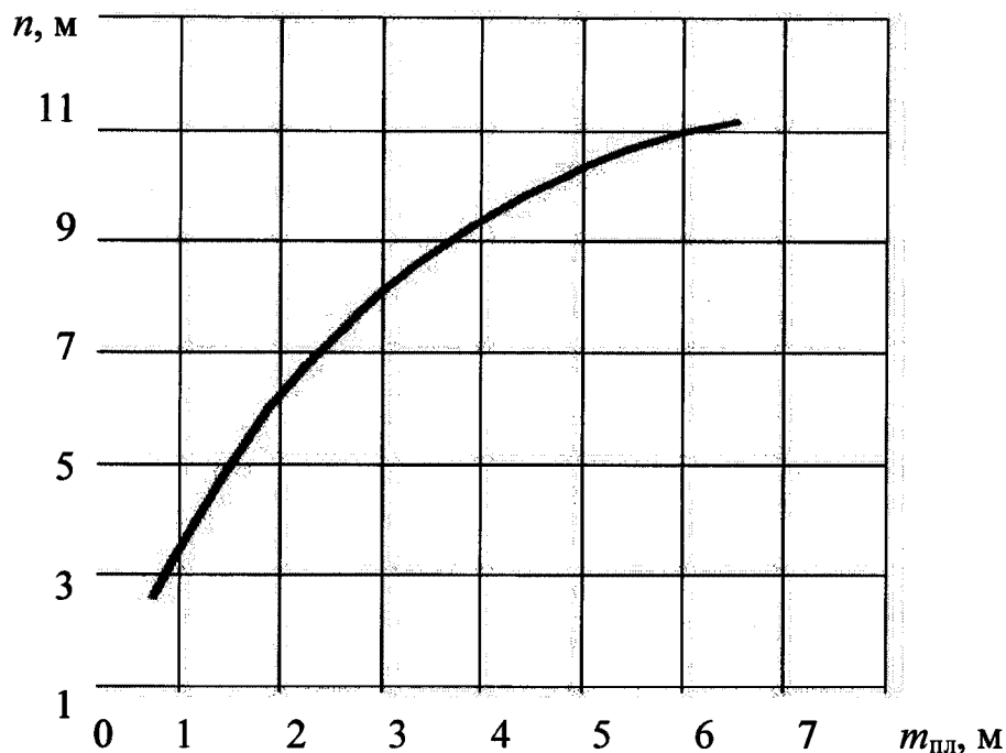
Рис. 6. Номограмма для определения ширины защитной зоны в краевой части угольного пласта.
