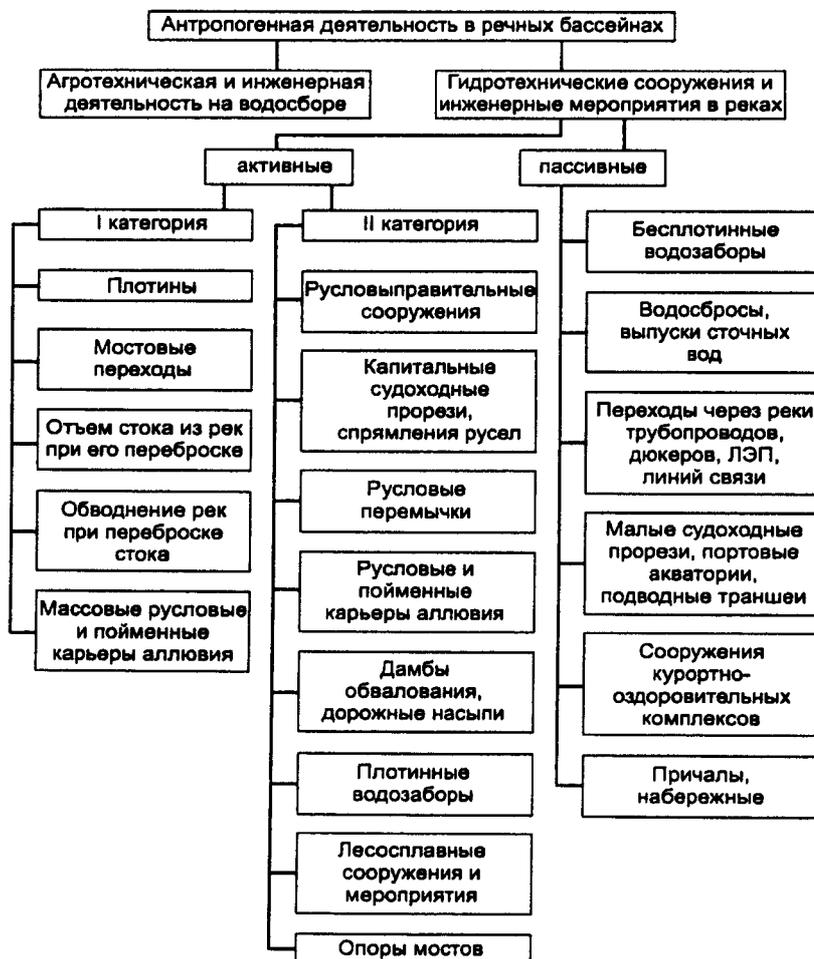
1. В соответствии со степенью инженерного влияния на определяющие факторы руслового процесса все речные инженерные сооружения и мероприятия делятся на активные и пассивные. Воздействие активных сооружений и мероприятий приводит к изменению определяющих факторов, пассивные
